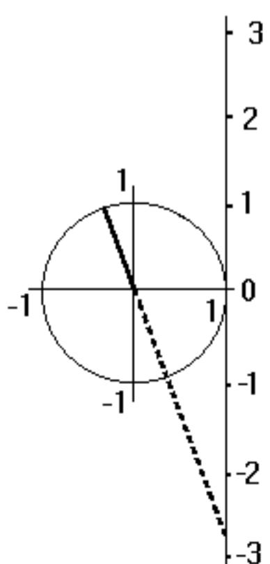
Im dritten Beispiel drehen wir den positiven Teil der x-Achse um  $110^\circ$ . Es entsteht eine Gerade (dick gezeichnet). Diese Gerade müssen wir nun wieder in Richtung Tangente (rückwärts) verlängern. Die Verlängerung (Punktlinie) schneidet die Tangente ca. bei -2,75, also ist der Tangens von  $110^\circ$  ca. gleich -2.75
