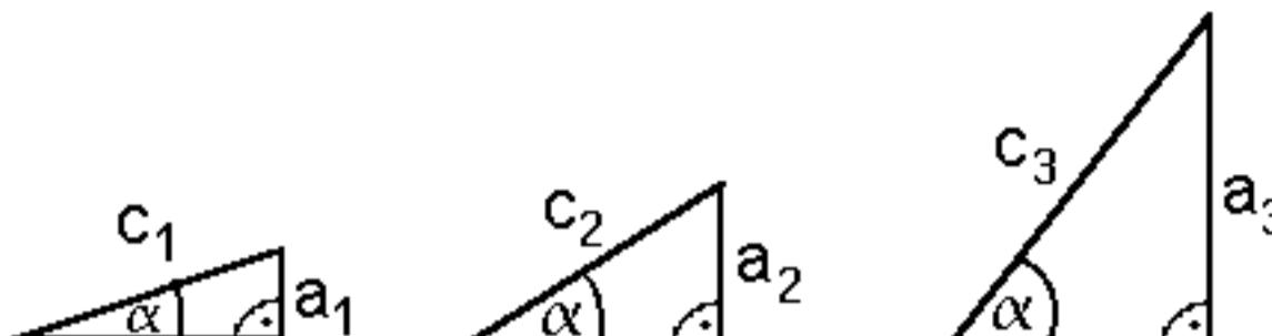
Nun zum Seitenverhältnis Ankathete von  $\alpha$  / Hypotenuse (Bild:  $b/c$ ). Diese Seitenverhältnis nennt man den Cosinus von  $\alpha$ . Auch der Cosinus ist vom Winkel  $\alpha$  abhängig, und von der Größe des Dreiecks unabhängig:
