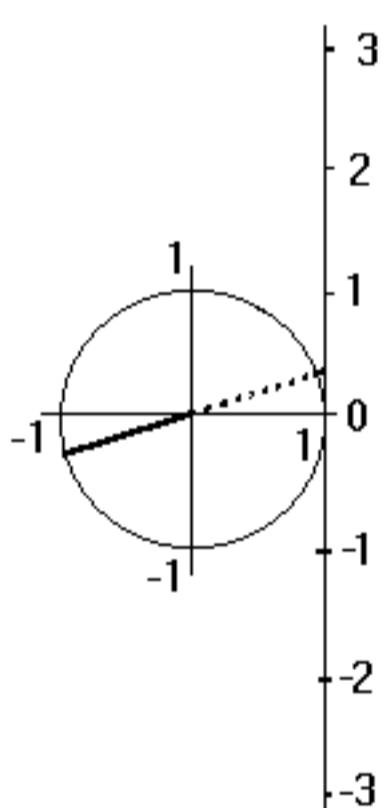
Im zweiten Beispiel drehen wir den positiven Teil der x-Achse um  $200^\circ$ . Es entsteht eine Gerade (dick gezeichnet). Diese Gerade müssen wir nun in Richtung Tangente (also rückwärts!) verlängern. Die Verlängerung (Punktlinie) schneidet die Tangente ca. bei 0.36, also ist der Tangens von  $200^\circ$  ca. gleich 0.36.
