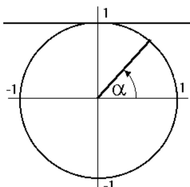
Nun drehen wir den positiven Teil der x-Achse um einen beliebigen Winkel  $\alpha$ , im Beispiel um ca.  $50^\circ$ :
