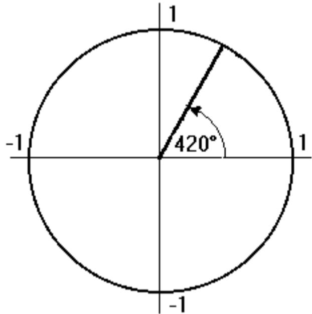
Dann ist dies identisch mit einer Drehung um  $60^\circ$ :
