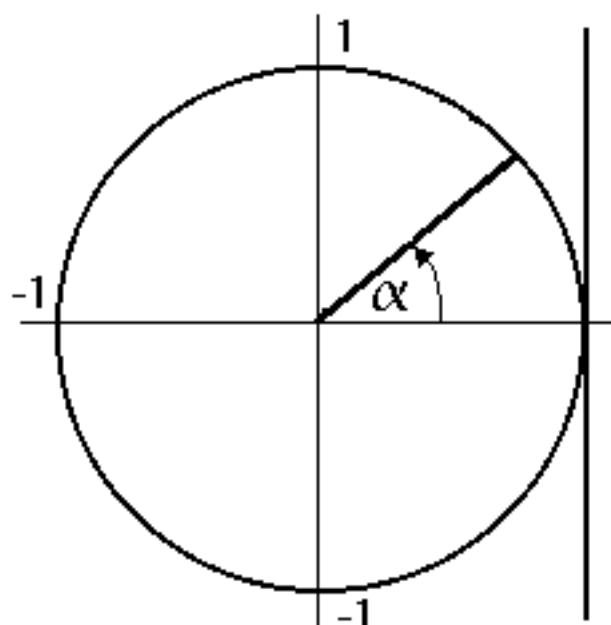
Nun drehen wir den positiven Teil der x-Achse um einen beliebigen Winkel  $\alpha$ , im Beispiel um ca.  $40^\circ$ :
