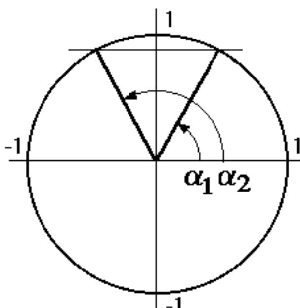
Jetzt können wir den Winkel  $\alpha$  messen. Der Winkel  $\alpha_1$  ist  $64^\circ$ , der Winkel  $\alpha_2$  ist  $115^\circ$ . Sinus = 0.9 tritt also bei zwei Winkeln auf.
