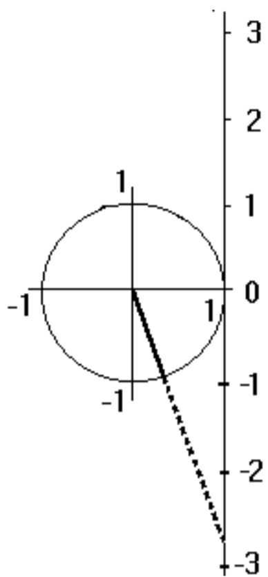
Im ersten Beispiel drehen wir den positiven Teil der x-Achse um  $290^\circ$ . Es entsteht eine Gerade (dick gezeichnet). Diese Gerade müssen wir nun in Richtung Tangente verlängern (Punktlinie). Die Punktlinie schneidet bei ca. -2.75 die Tangente. Der Tangens von  $290^\circ$  ist also gleich -2.75
