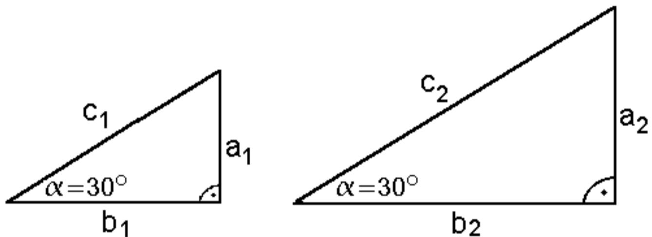
Exemplarisch überprüfen wir eines der sechs möglichen Seitenverhältnisse, z.B. das Verhältnis Gegenkathete  $\alpha$  / Hypotenuse. Im Beispiel entspricht dies dem Verhältnis a/c:
