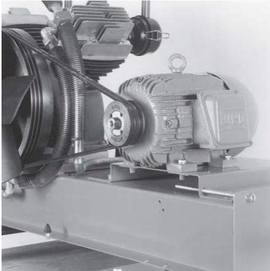
Bild 3.39: Antriebsmotor mit Keilriemen und Riemen- spannvorrichtung
